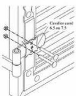
Solidariser l'ensemble à l'aide de vis TRCC et écrous.
