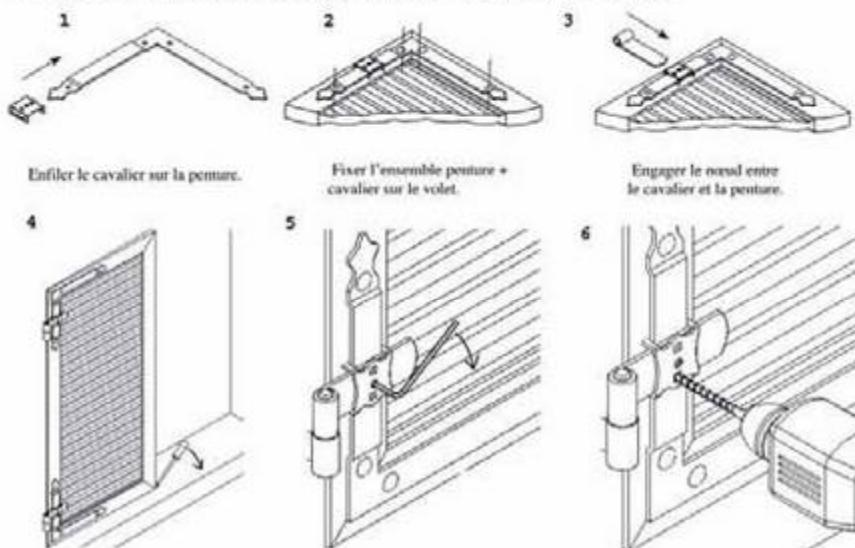
Acrocher le volet sur les gonds de façade et le faire pivoter en position de fermeture.
